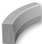
78 x 15 x 25 Silniční obrubník I oblý (vnitřní) vnitřní rádius r = 1,0 m, 8 ks/1 kruh hloubka pro zapuštění 10 cm
