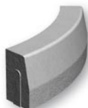
78 x 15 x 25 Silniční obrubník I oblý (vnější) vnější rádius r = 1,0 m, 8 ks/1 kruh hloubka pro zapuštění 10 cm
