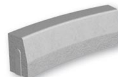
78 x 15 x 25 Silniční obrubník I oblý (vnitřní) vnitřní rádius r = 2,0 m, 16 ks/1 kruh hloubka pro zapuštění 10 cm
