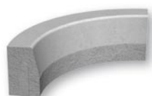
78 x 15 x 25 Silniční obrubník I oblý (vnitřní) vnitřní rádius r = 0,5 m, 4 ks/1 kruh hloubka pro zapuštění 10 cm
